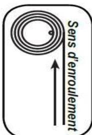
Attention au sens d'enroulement de votre store vertical, la toile doit tomber verticalement au-dessus de vos coulisses de façon à ne pas s'endommager. Donc fixez vos supports de tube ou vos coulisses selon vos contraintes, la fixation de l'un entraînant le lieu de fixation de l'autre. Donc cet élément est à déterminer d'entrée, afin de ne pas avoir à modifier votre travail par la suite.
