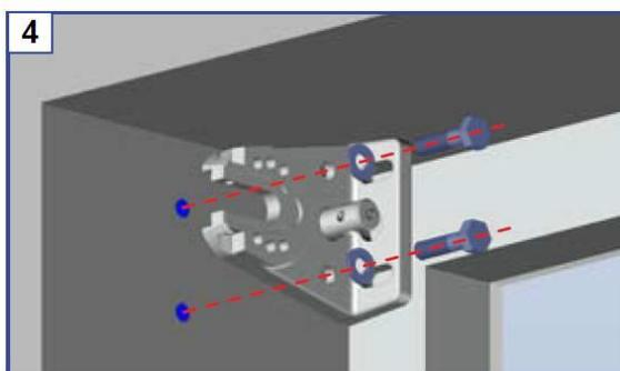
Fixation avec des vis  $\varnothing 10\text{mm}$ . Kit de vis, cheville et rondelle non fournis.
