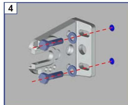
Fixation avec des vis  $\varnothing 10\text{mm}$ . Kit de vis, cheville et rondelle non fournis.
